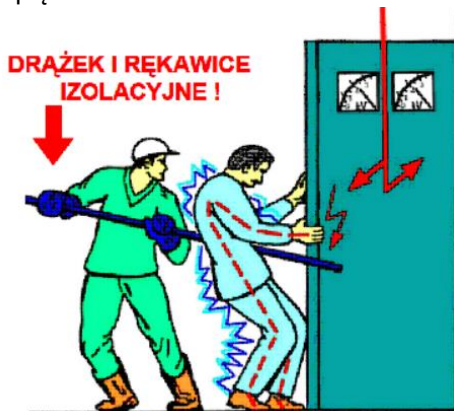
Rys. 8 Uwalnianie porażonego prądem elektrycznym o napięciu powyżej 1kV przez odciągnięcie od urządzeń będących pod napięciem
